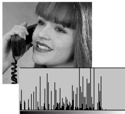
Figura 1: un'immagine originale scura. Si noti come i dettagli di ombreggiatura siano spostati verso le aree scure. I dati dell'istogramma sono giustificati a sinistra.
