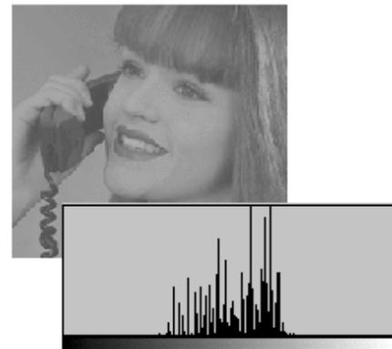
Figura 2. Un'immagine a basso contrasto. I livelli di grigio vengono compressi nelle tonalità medie e si verifica una perdita nella tonalità chiare e nelle ombre, come evidenziato nell'istogramma.
