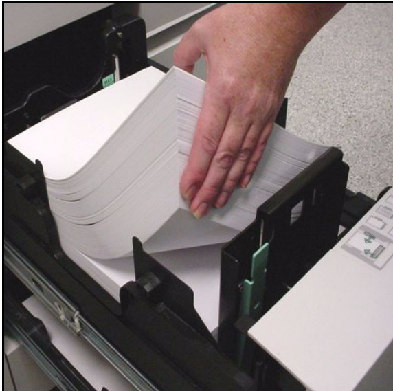
Abb. 2-5: Auffächern der Führungskante
